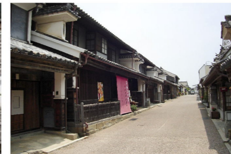
脇町のうだつ 妻側の袖壁を桁まで延ばさず小屋根を付けた形式の「うだつ」が多く見受けられます
