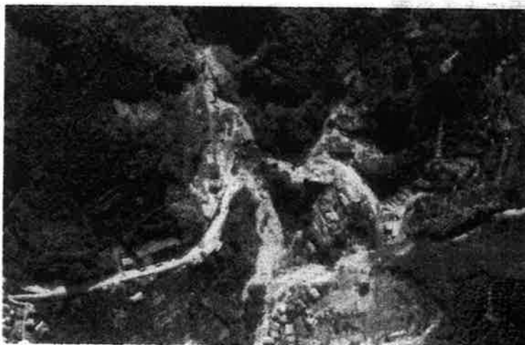
国道34号(芒塚付近)大規模崩壊
