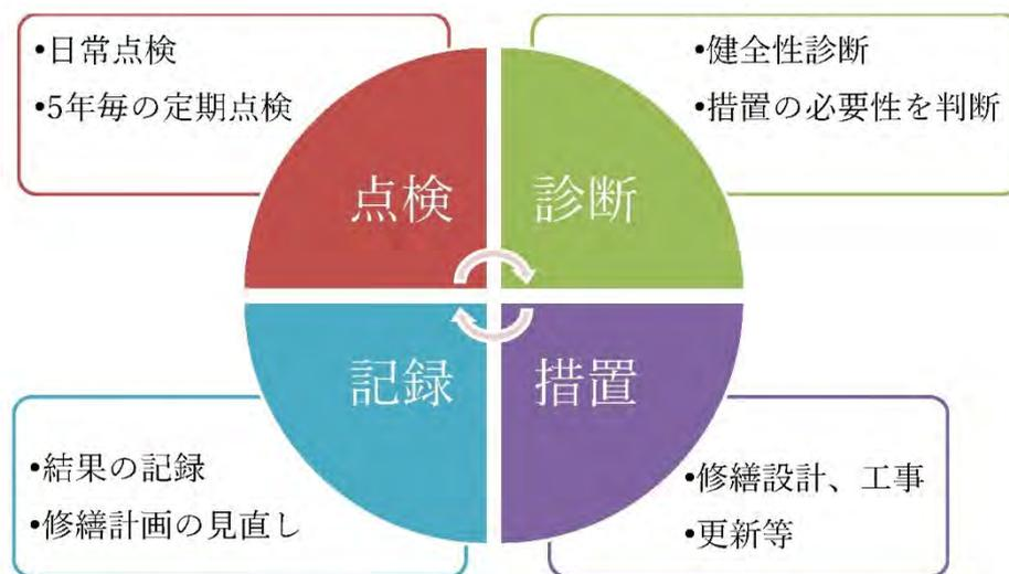
図4 メンテナンスサイクルの構築
